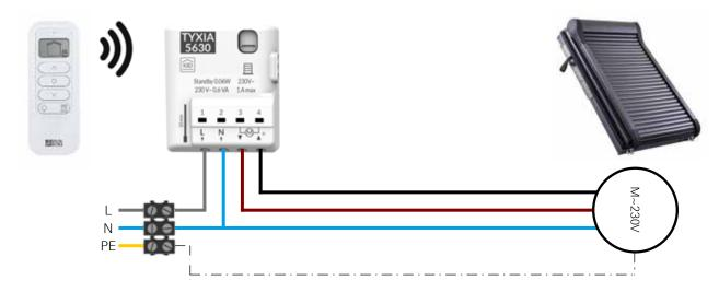
Le mouvement de l'ombrage Roto s'effectue tant que le relais est sous tension.
